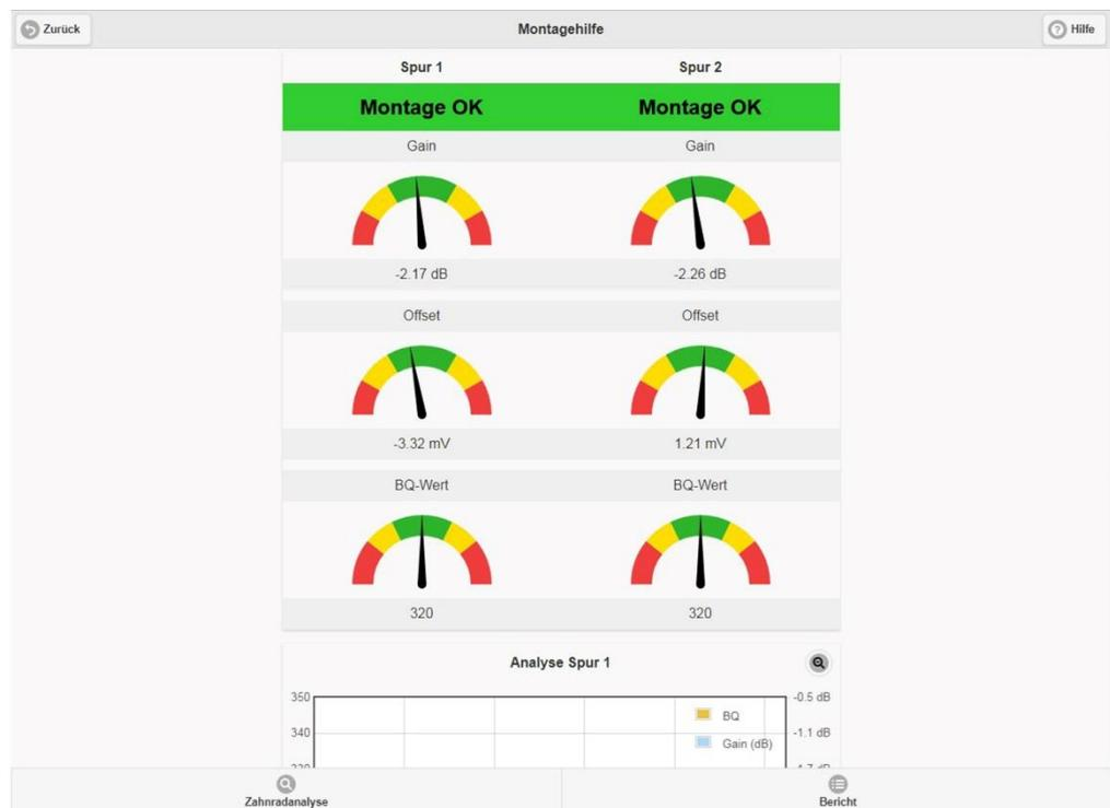
Bild 3: Montagehilfe im Webbrowser: Wenn alle Anzeigen im grünen Bereich sind, ist der Sensor richtig montiert
