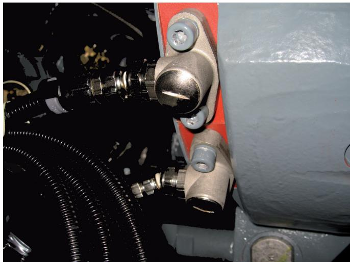
我们的转速传感器能够精确、可靠地测定 0 Hz 以上的运动和 25 kHz 以下的快速旋转运动。因为它们可以非接触式工作，因此完全免维修和无磨损。
