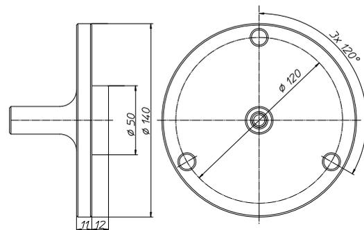
Rotorflansche können in verschiedenen Abmessungen für unterschiedliche Anwendungen geliefert werden.
