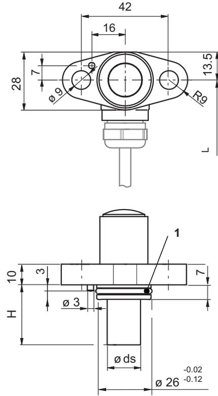
1 Dichtring: O-Ring 21 x 2,5 mm; NBR
