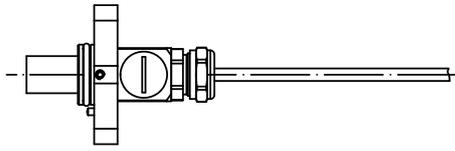
Standard, ohne Kabelschutz, Abgang gerade
