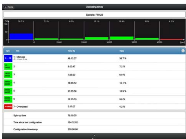
不同转速范围内的运行时间 带有特殊设备 P 的 MiniCODER 中可配置运行时间计数器的 可视化
