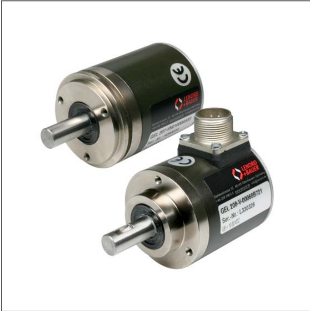
轴负载能力最高达 200 N 的旋转编码器 夹紧法兰 GEL 208 或同步法兰 GEL 207
